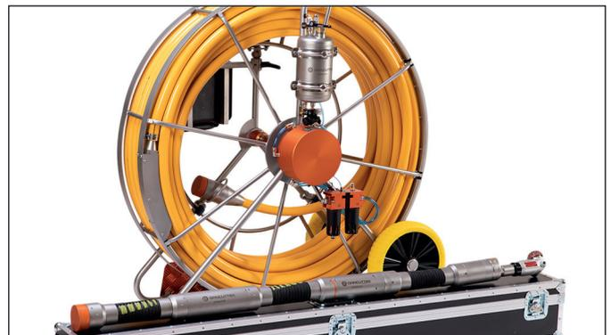
6. Rollen Sie den gelben Versorgungsschlauch wieder auf dem Schlauchhaspel auf und legen Sie den Fräser in den Transportbehälter.
