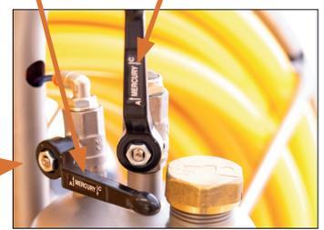
Trennen Sie den Fräser vom gelben Versorgungsschlauch. Die beiden Schutzkappen von Fräser bzw. Schlauch müssen befestigt werden, damit kein Schmutz in den Fräser bzw. Schlauch gelangt.
