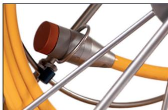
Legen Sie den Fräser vor den gelben Schlauch und schrauben Sie die beiden orangen Schutzkappen ab. Schieben Sie die beiden Enden zusammen und schrauben Sie die Überwurfmutter des gelben Schlauchs zum Fräser hin fest zusammen.
