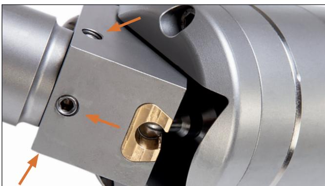
1. Lösen Sie die 3 Schrauben mit dem Innensechskantschlüssel.
