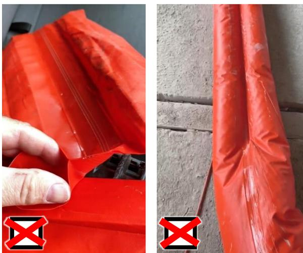
Fig. 1-2: verklebter Kalibrierschlauch
